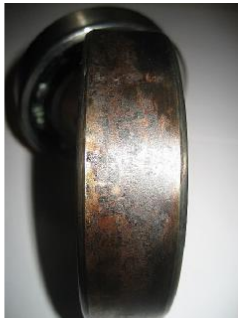
Stort leje med fastbrændt olie på yderside
